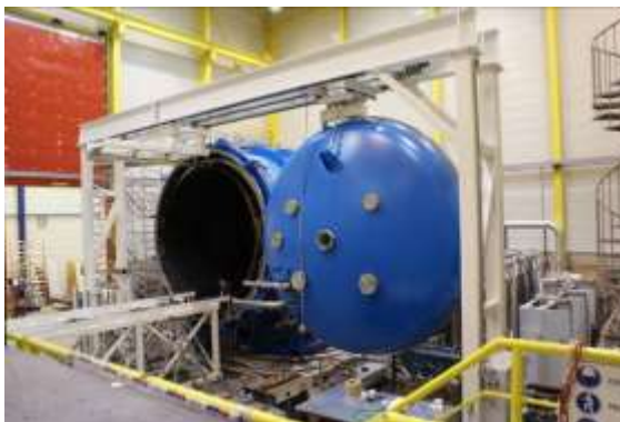
ATVF – Cuve à vide thermique pour le VSSC (ISRO)
