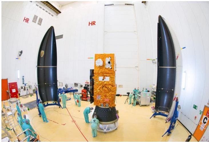
Encapsulation de Sentinel 2B dans la coiffe de Vega (Copyright ESA)
