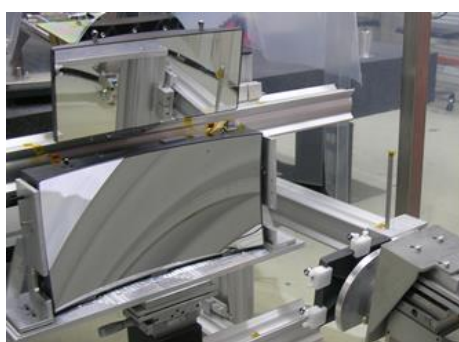
Les optiques de Sentinel 2B en cours de fabrication dans les ateliers d'AMOS (Copyright AMOS)
