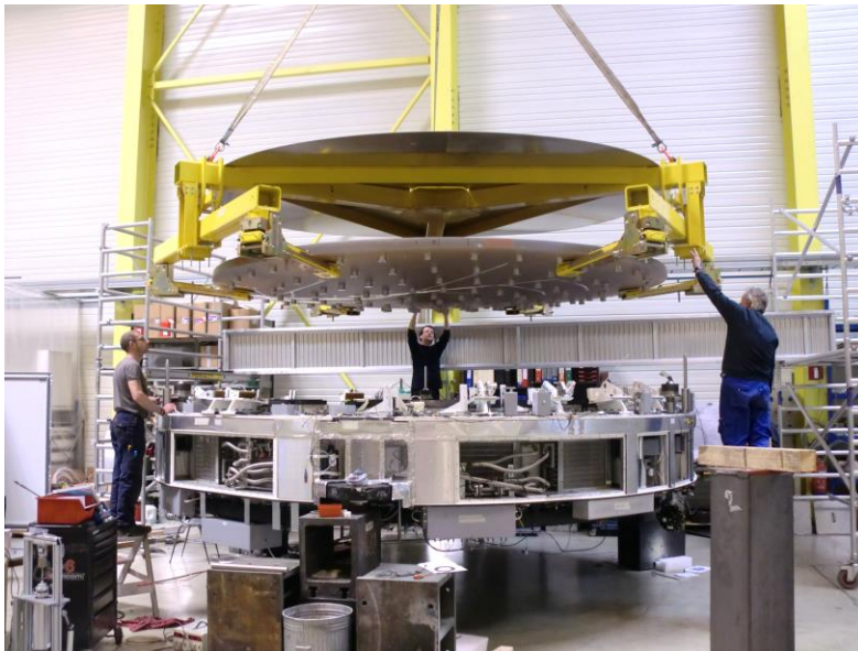
Cellule active solaire de 4.2m durant assemblage
