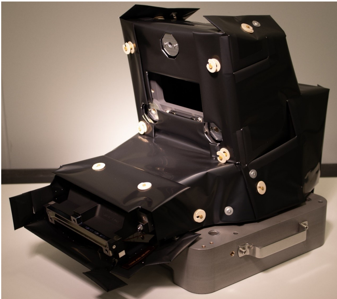
Version prototype d'un spectromètre, emballé dans un film de protection thermique
