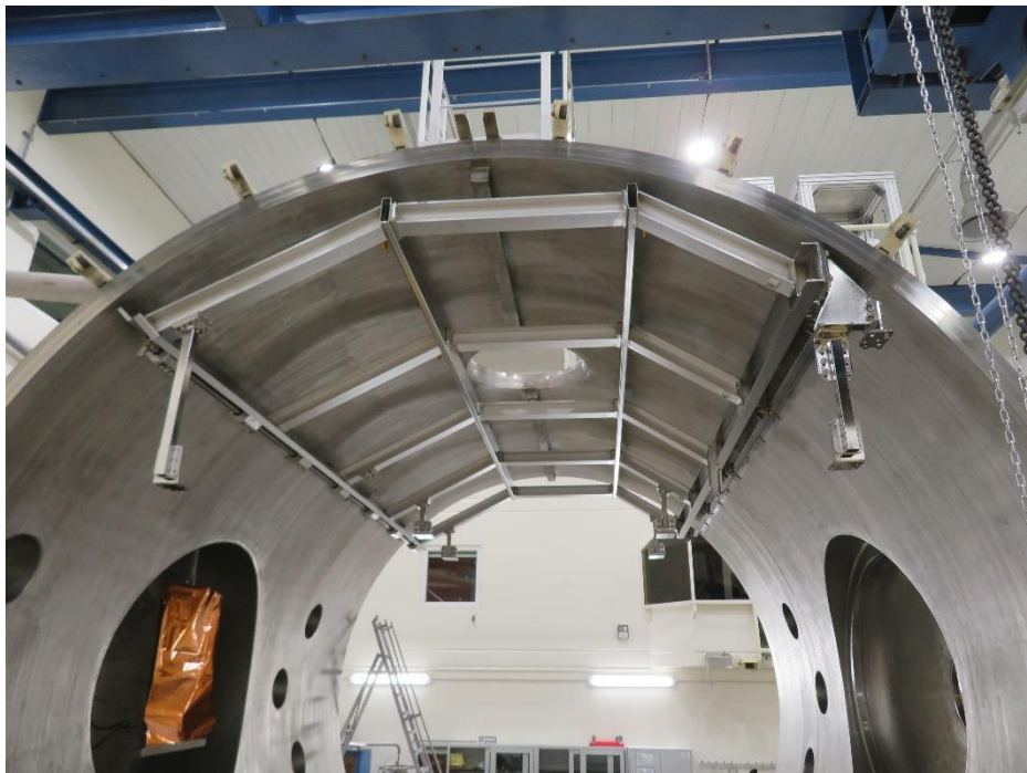
Structure de chariot élévateur intégrée à la cuve Focal 5
