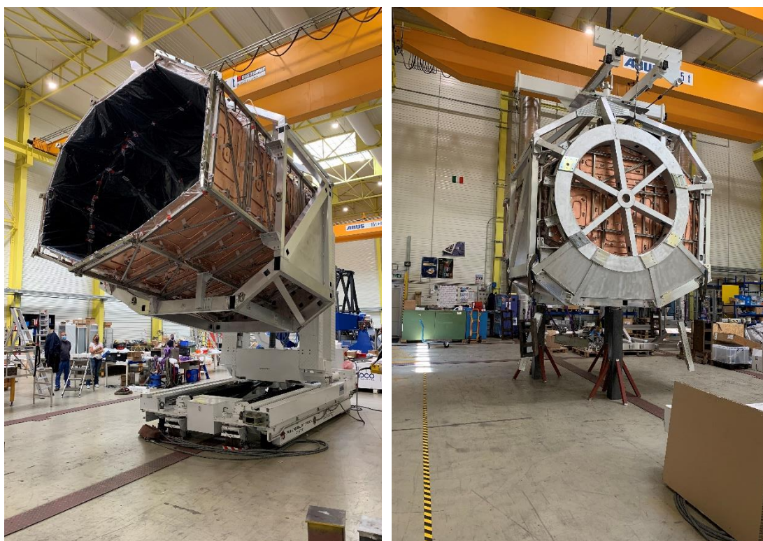
Tests de la tente thermique chez AMOS et du PSS intégrés sur le chariot Airbus DS
