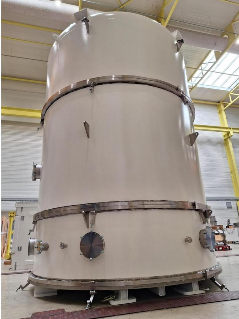
Chambre à vide pour tester de nouvelles suspensions anti-vibrations.
