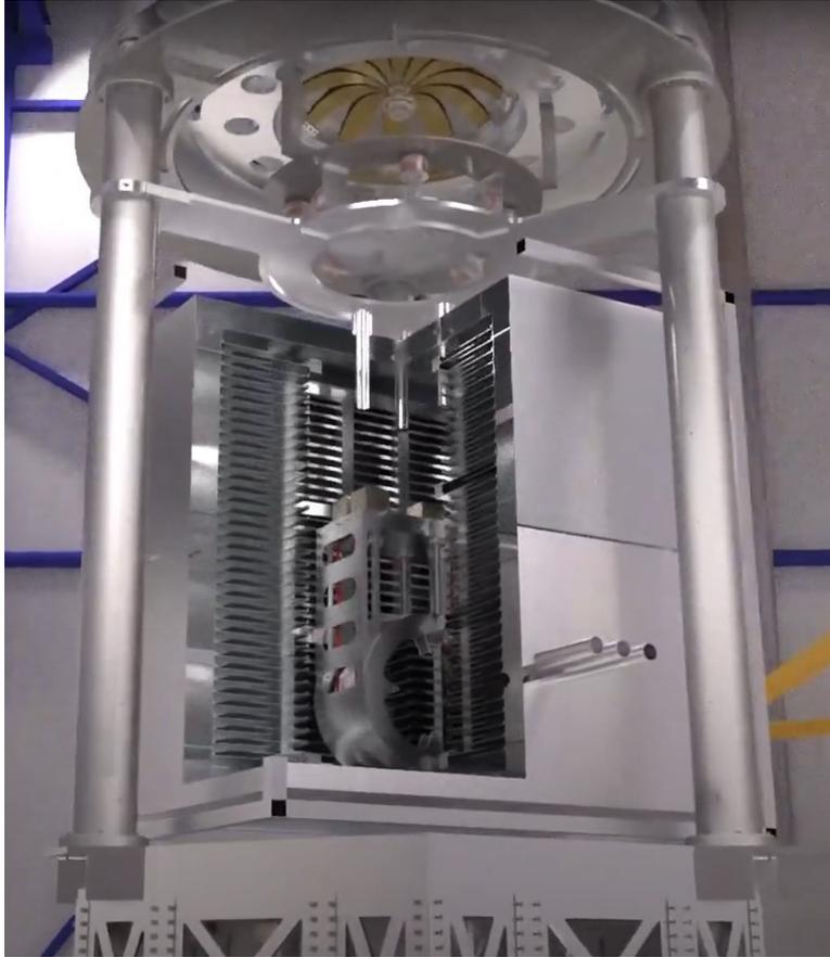
Miroir en silicium suspendu à l'intérieur du cryostat E-TEST
